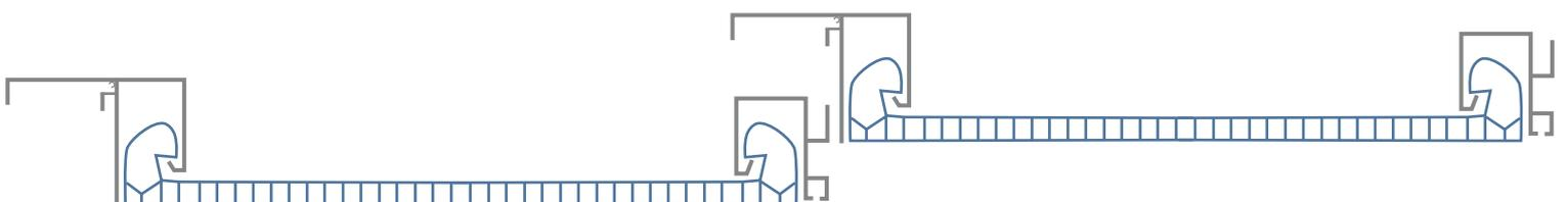
5. Para união dos sistemas modulares, encaixe em uma das extremidades o Perfil Skylight Macho e na outra encaixe o Perfil U B M base Skylight. Por fim una as chapas por meio dos perfis de alumínio.
