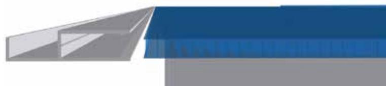
**3.** Aplique a fita porosa na parte inferior e a metálica na parte superior da chapa
