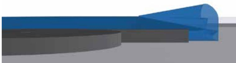
3. Aplique a fita porosa na parte inferior e a metálica na parte superior da chapa
