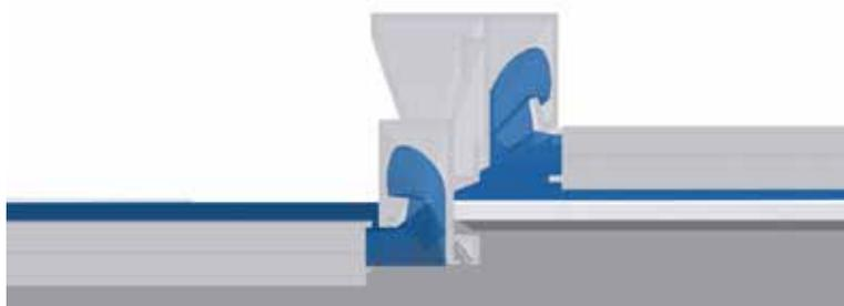
5. Para união dos sistemas modulares, encaixe em uma das extremidades o Perfil Skylight Macho e na outra encaixe o Perfil U B M base Skylight. Por fim una as chapas por meio dos perfis de alumínio.
